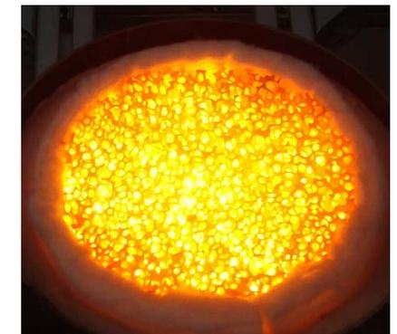
SiSiC-Schaum konisch ausgeführt zur geschwindigkeitskontrollierten Flammenstabilisierung
