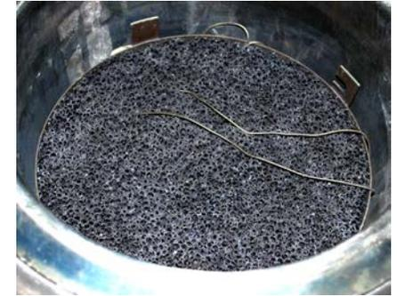
Katalysator im ATR-Reaktor
