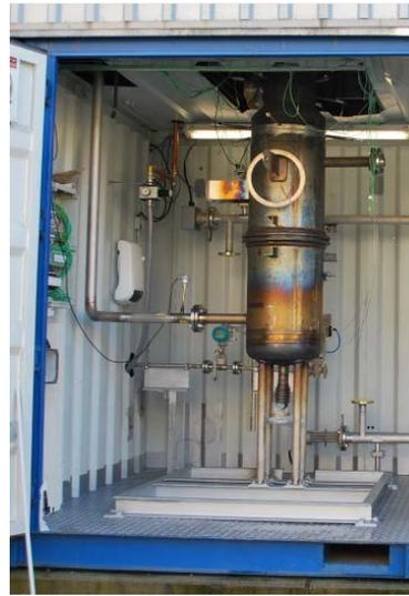
Links: BioRobur-Anlage auf dem Gelände des Instituts für Wärmetechnische Anlagen und Thermodynamik (IWTT) der TUBAF; rechts: ATR-Reaktor
